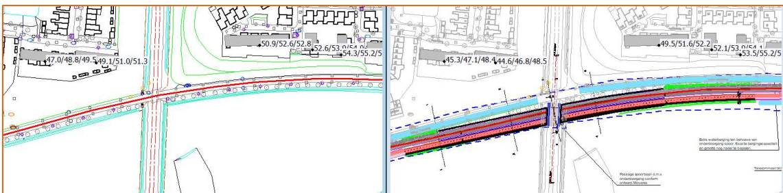
Figuur 6: geluidsbelasting van de Willem Dreesweg in 2020 (links) en 2030 (rechts), na aftrek van 5 dB conform artikel 110g Wgh. Langs dit wegvak neemt de geluidsbelasting af vanwege de verdiepte onderdoorgang in de toekomstige situatie. De genoemde cijfers geven de geluidbelasting weer voor 1,5m/4,5m/7,5m.
